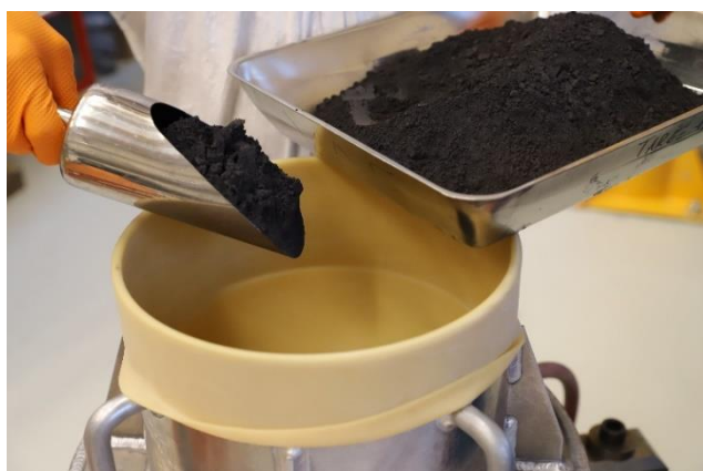
Figure 2 : Illustrations du poste de remplissage, avec la cage sur la virole. (Partie « contrainte »)
