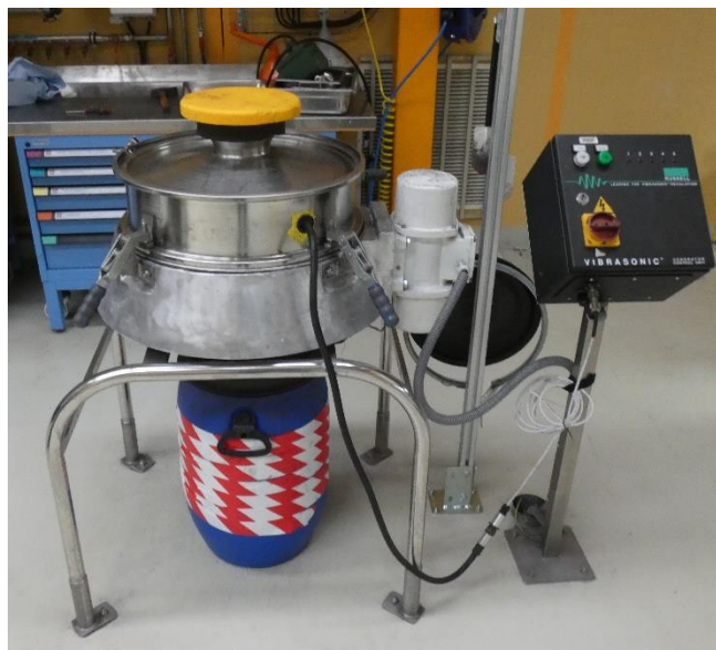
Figure 3 : Illustrations des postes de tamisage, avec leurs servitudes électriques
