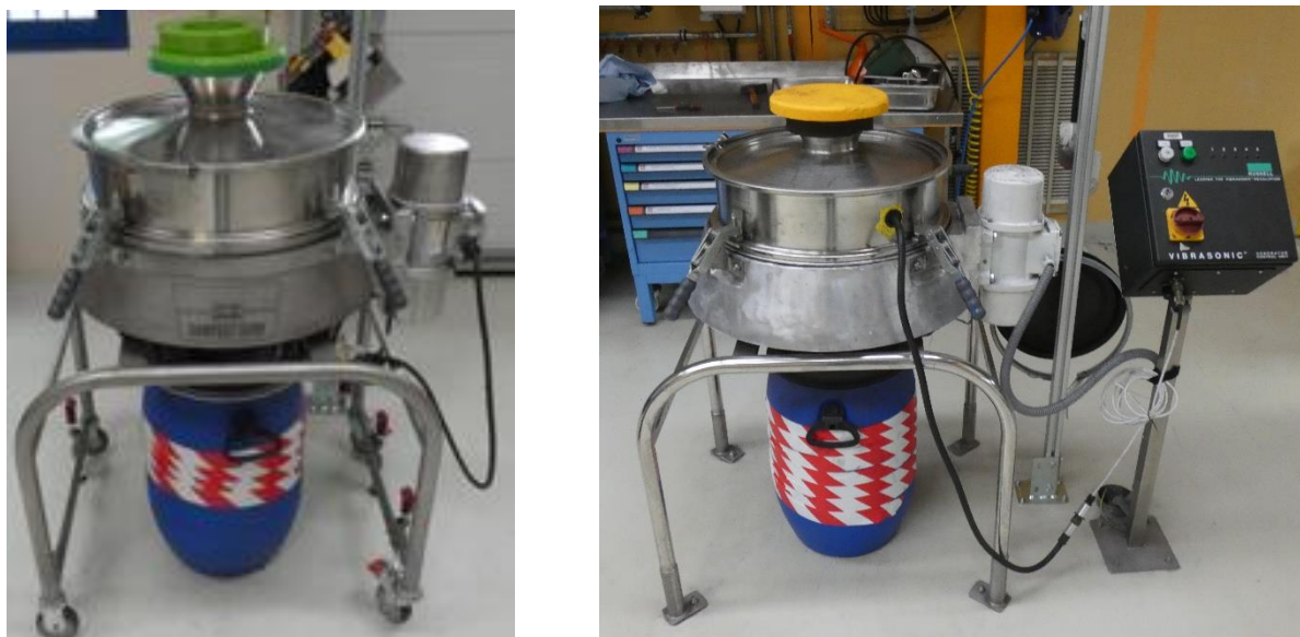
Figure 6 : Illustrations des deux postes de tamisage avec leur bidon de récupération
