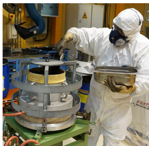
Figure 2 : Illustrations du poste de remplissage, avec la cage sur la virole. (Partie « contrainte »)
