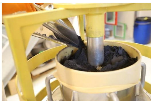
Figure 2 : Illustrations du poste de remplissage, avec la cage sur la virole. (Partie « contrainte »)
